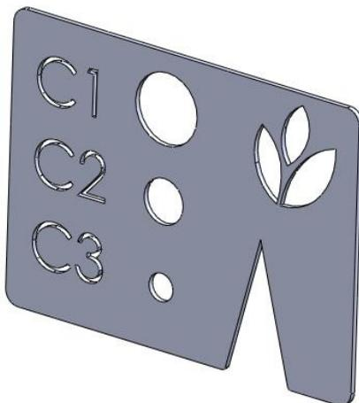
Se o cone passar pelo furo, destinado à sua dimensão, ou não estiver coincidindo com o ângulo, então é necessário trocar a Haste Removível.
