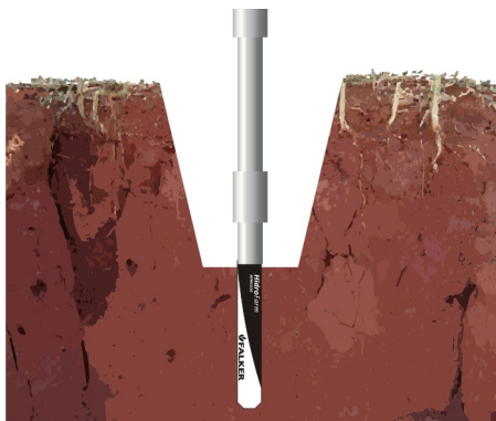
Figura 9: Sensor instalado na subsuperfície do solo juntamente com o extensor, após a abertura da trincheira
